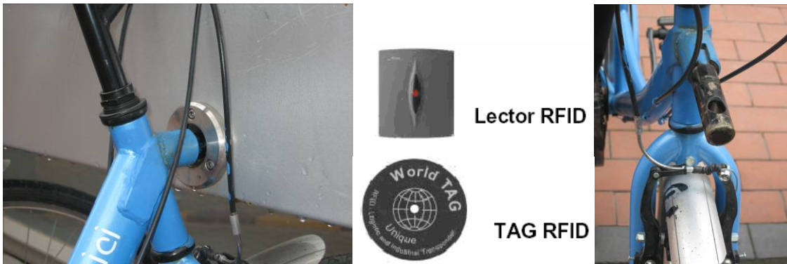
図 3(8)-3 RFID タグによる車両認識
